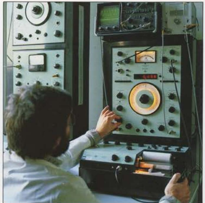
Untersuchung der Trommelschwingungsformen: Sinusgenerator zur Anregung der Trommelschwingungen. Links im Bild Terz-Analysator zur Messung der Ausklingzeiten.
