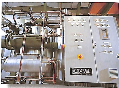
In der Lackierabteilung werden Lösungsmittel wieder zurückgewonnen.
