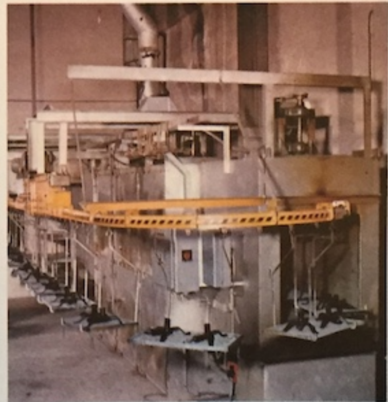
Alle Metallteile werden verkupfert, vernickelt und verchromt.
